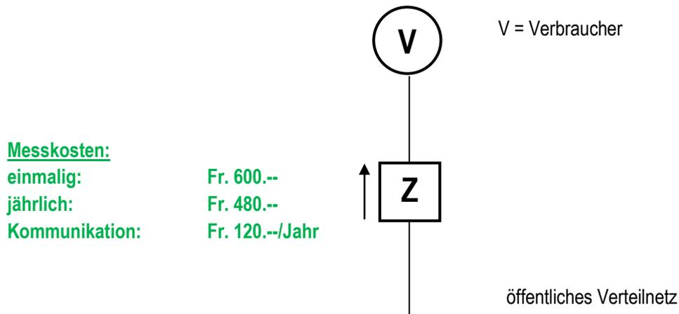
**[4.1] Messanordnung: Eigenverbrauch über 30 kW Stromerzeugungsanlagen (z.B. Photovoltaik)**
